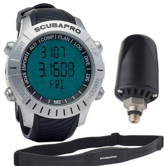
Abbildung 22 Die Fitness-Uhr übernimmt die Funktion eines leistungsfähigen Tauchcomputers. Der Brustgurt liefert aktuelle Daten, die in die Deko-Berechnung einfließen. Quelle: https://www.u1tauchshop.de/SCUBAPRO-M2-mit-Sender-und-Brustgurt/11298301//
