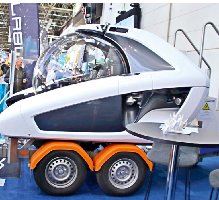
Abbildung 6 Wer eine stattlichen SUV fährt, kann das Tauchboot Memo auf den Trailer laden, hinter sich herziehen und im Comer See oder in der Ägäis auf maximal 300 m abtauchen. Foto: JD Schipke
