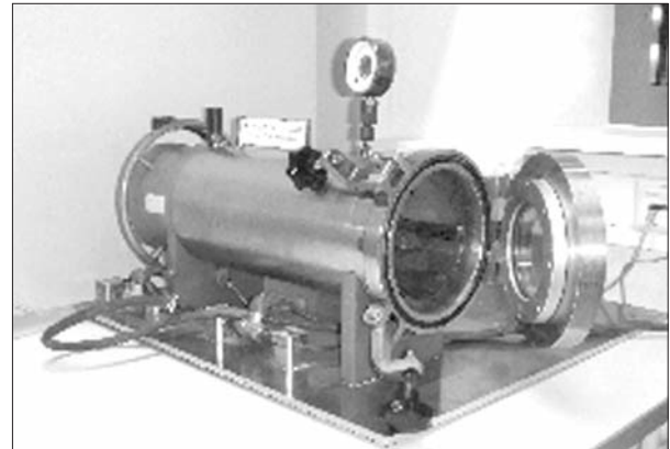
Abb. 1: Experimentelle Druckkammer für die Behandlung von embryonalen Stammzellen. Eine Standard-HBO-Behandlung wurde mit 99 % Sauerstoff bei 2,8 bar über 90 min durchgeführt.
