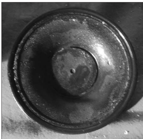
Abb. 2: Membran in der zweiten Stufe eines Atemreglers. Auf der 'trockenen Seite' fanden sich Reste von Erbrochenem (kleine weiße Punkte).
