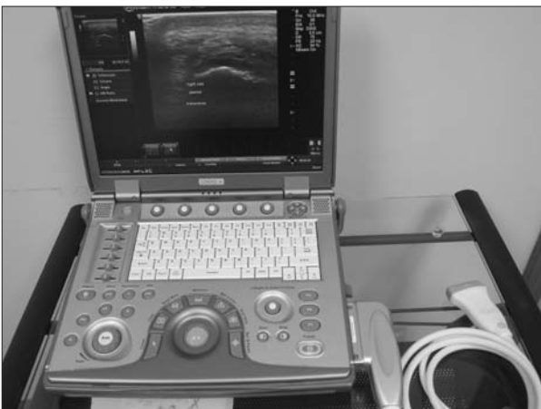
Abb. 1: Ultraschall-System in Laptop-Ausführung. Das gesamte System enthält keine Elemente, in denen sich Druckdifferenzen entwickeln könnten. Rechts im Bild eine von mehreren Sonden. Für die Anwendung in einer Kammer mit Überdruck wurde eine Reihe von Modifikationen nötig.
