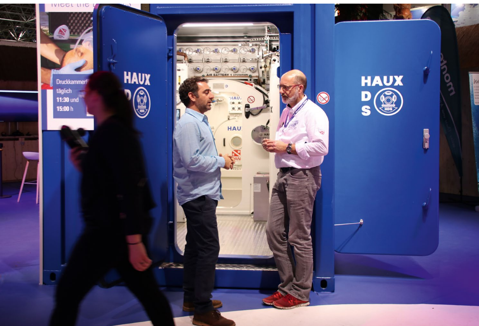
Abbildung 3 Haux-Druckkammer mit Fahrstand, O 2 - und Pressluft-Vorrat und Atemluftkompressor im 20 Fuss-Seecontainer. DAN-Taucherärzte standen für tauchmedizinische Fragen zur Verfügung (Foto: Jochen D Schipke)
