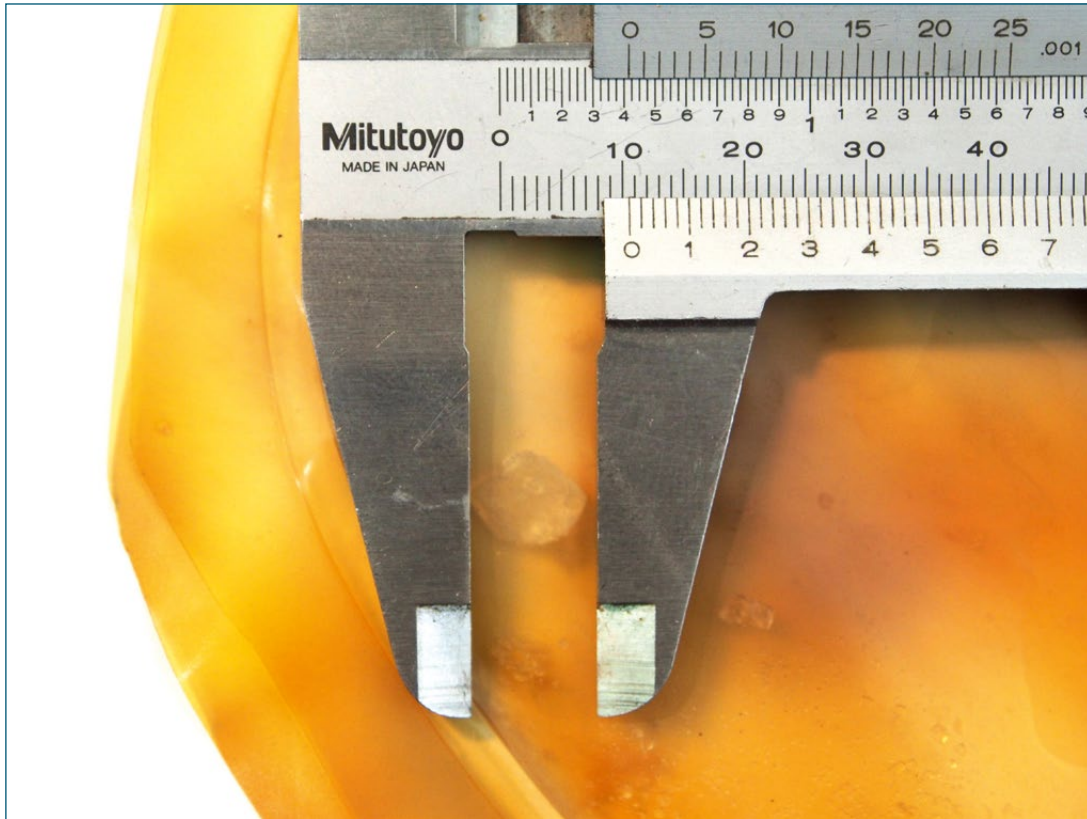
Abbildung 32 Salzkristalle in einer Jacketblase (Foto: Ralf Krause).
